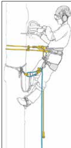
Figura 14. Corte de tronco descendiendo con salvarramas situado debajo de la eslinga. ©PETZL.
