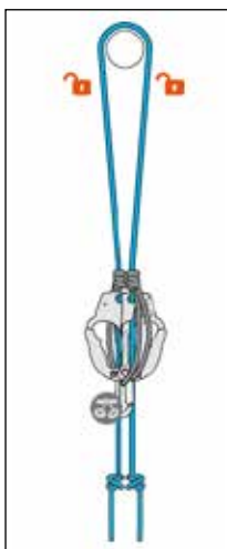
Figura 20. Bloqueador de dos asas. ©PETZL.
