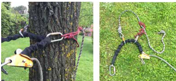
Figura 12. Fijación de la eslinga con un sistema regulable.
